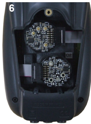
6 Connexion de la nappe et de la cellule
