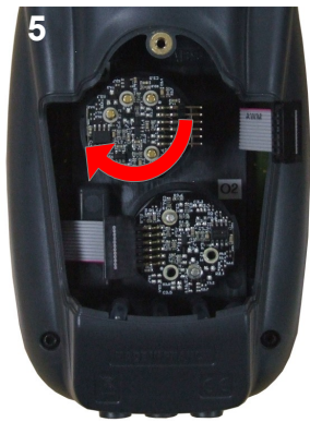
5 Insertion d'une nouvelle cellule puis rotation de la cellule
